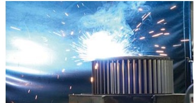
ブローラの溶接加工
